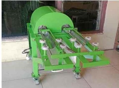
**Gambar 2.3** Mesin pengiris tempe dengan pendorong *double line springs* (Alfauzi, dkk. 2023).
