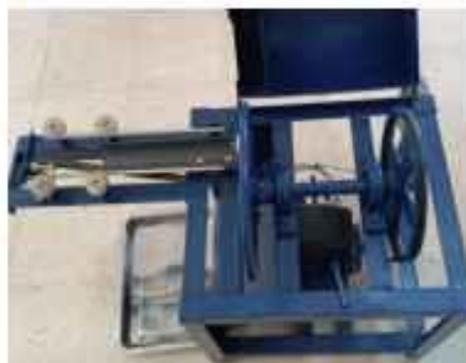
**Gambar 2.4** Mesin Pengiris tempe dengan pendorong pegas tarik (Istiadi, dkk. 2022).
