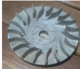
Gambar 2.4 Dinding luar puli penggerak dan kipas pendingin.
