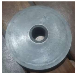
Gambar 2. 5 Dinding dalam puli penggerak
