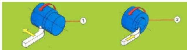
Gambar 2. 2 Gerakan makan proses pembubutan rata dan gerak proses pembubutan muka (Widarto, 2008).
