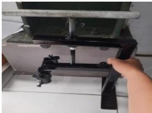
Gambar 2. 1 Produksi *Holder* Alat Bantu Pencekam Benda Kerja (Huda dkk, 2021).
