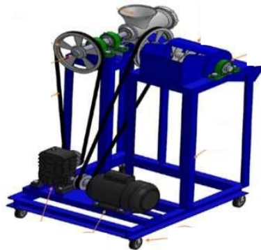
Gambar 2.2 Desain mesin pelet ( Iskandar dkk, 2022 )
