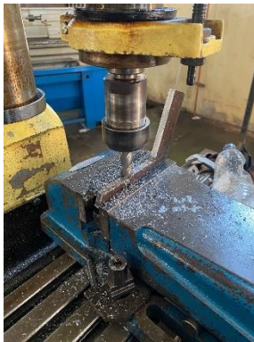
Proses pengefraisan gagang pisau kanan dan dudukan pisau bawah
