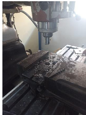
Proses pengefraisan gagang pisau kanan dan dudukan pisau bawah
