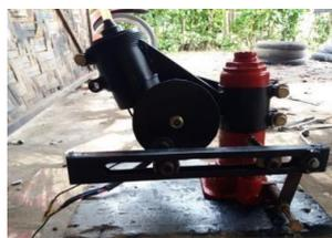
Gambar 2.3 Modifikasi Dongkrak Hidrolik Botol Menjadi Dongkrak Hidrolik Elektrik Dengan Aki Mobil Sebagai Sumber Arusnya.
