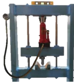
Gambar 2.1 Mesin Uji universal untuk pengujian tarik dan tekuk bertenaga hidrolik (Sutisna et al., 2021)
