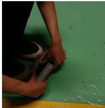
Gambar 1.1 Pengujian Tarik sealant di PT. Mekar Armada Jaya (dokumentasi PT. Mekar Armada Jaya)
