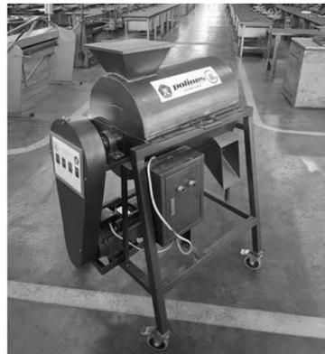
Gambar 2. 2 Mesin pengurai sabut kelapa menjadi *cocopeat* dan *cocofiber* Satito, dkk (2020)
