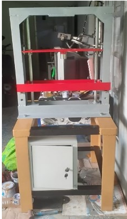
Gambar 2 Dokumentasi Rangka Mesin Hot Press Hidrolik 10 Ton Untuk Cetakan Spesimen Bahan Uji Komposit Fiberglass
