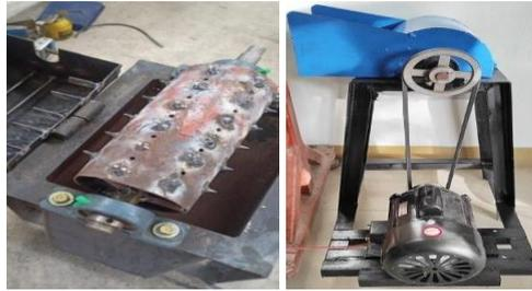
Gambar 2.2 Mesin Pengurai Sabut Kelapa dengan Modifikasi Pisau Pengurai
