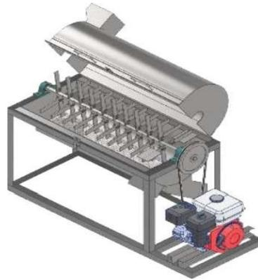
Gambar 2.3 Mesin Pengurai Sabut Kelapa Menjadi *Cocopeat* dan *Cocofiber*
