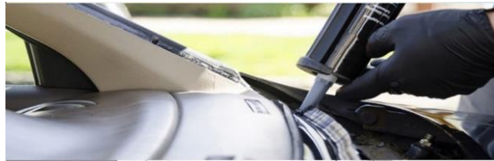
Gambar 2. 1 Penggunaan sealant pada kaca mobil
