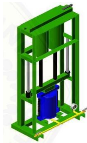
Gambar 2. 2 Desain alat cetak kompos blok (Muhakiki, 2019)
