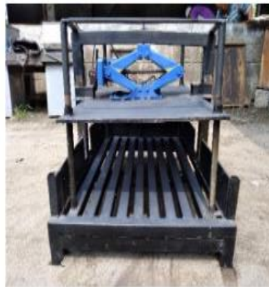
Gambar 2. 3 Mesin pres ampas kedelai dengan sistem ulir semi otomatis (Danu pamungkas, 2021)
