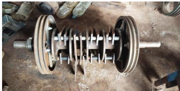
Gambar 2.7 Pisau hammer mill (Lubis dkk, 2023)
