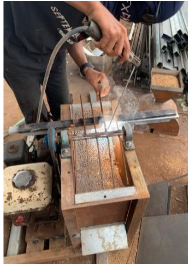
Gambar 2.5 Proses pembuatan pisau dan mata pisau penghalus sekam padi (Rahmadhan dkk, 2023)
