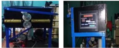
Gambar 2. 1 Alat Pemotong Kabel Otomatis *Berbasis Programmable Logic Controller* dengan HMI NB7W-TW00B (Berlianti & Nasrul, 2020)
