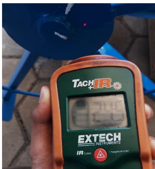
Gambar 4.42 Pengujian putaran poros roda
