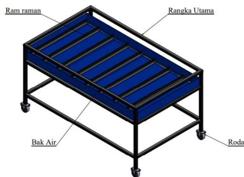
**Gambar 4. 7** Rangka meja mesin CNC *plasma cutting*
