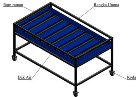
**Gambar 4. 20** Rangka meja mesin CNC *plasma cutting*
