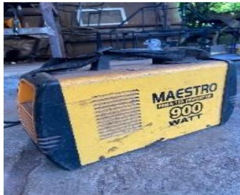
**Gambar 2.10** Mesin las SMAW maestro 900 watt
