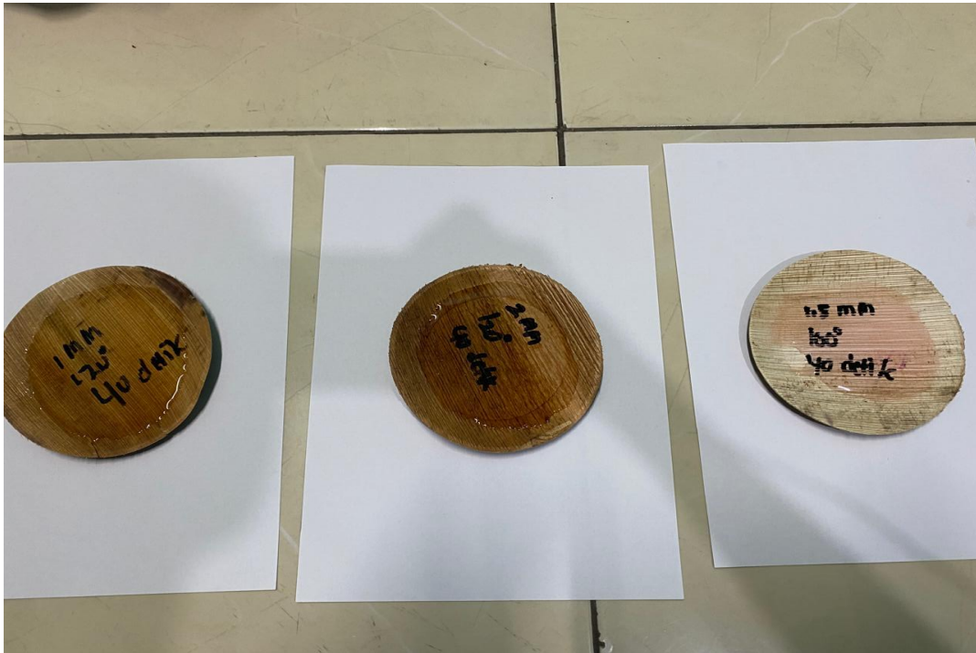
Pengujian dengan menggunakan air untuk melihat kebocoran
