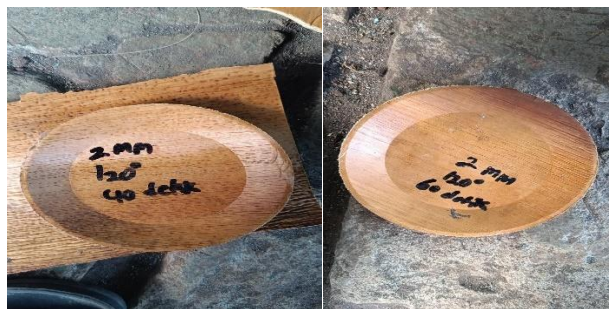
Pengujian dengan suhu 120° dengan ketebalan 2 mm dan waktu tekan 20, 40, 60
