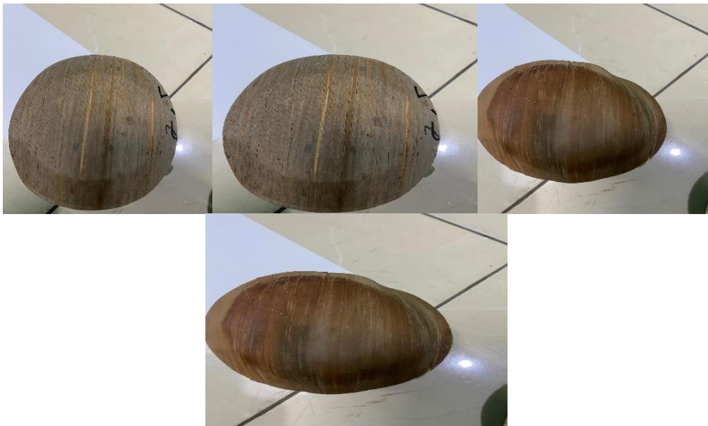
Hasil pengujian menggunakan air didapat jika pelepah pinang kering air tidak rembes, tetapi jika pelepah pinang tidak kering air mengalami rembes
