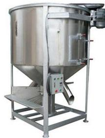
Gambar 2. 7 Mesin pengaduk sumbu *vertical*
