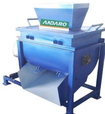
Gambar 2. 8 Mesin Pengaduk sumbu Horizontal
