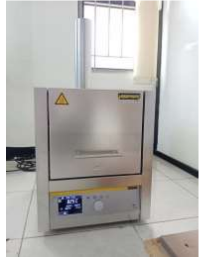
Proses pengujian kadar abu dan kadar zat menguap
