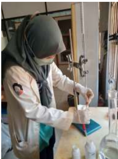
Proses pengujian daya serap iodin
