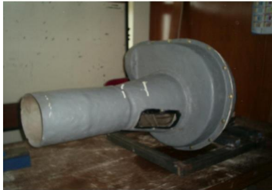
Gambar 2.2 Hasil perancangan blower sebagai sirkulator udara (Yunus dkk. 2011)
