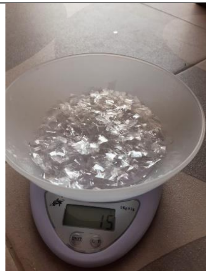
Proses Penimbangan Massa Input Bahan Baku
