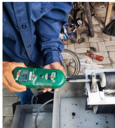
Gambar 12 Proses pengukuran kecepatan ( rpm ) menggunakan tachometer
