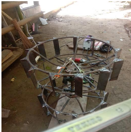
Gambar 15 Proses Pengelasan Dudukan Roda
