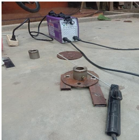
Gambar 15 Proses Pengelasan Dudukan Roda
