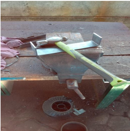
Gambar 12 Proses Pembengkokan Besi Plat
