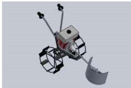
Gambar 2. 5 Desain mesin pemotong padi mini (Wahid & Erwanto, 2020)
