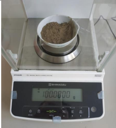
Penimbangan 100 gram fly ash batubara yang telah diayak menggunakan ayakan 100 mesh
