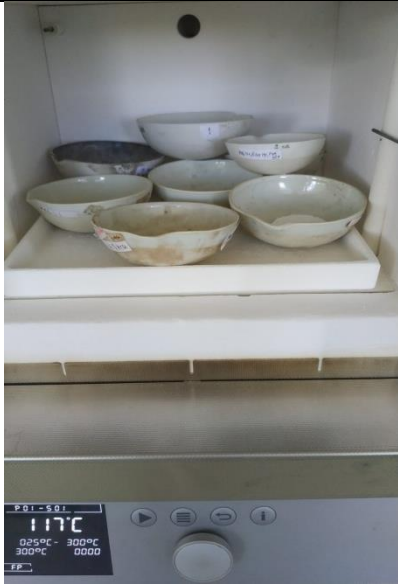
Proses sintering membran silika menggunakan furnace pada suhu 600°C selama 2 jam
