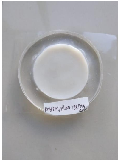
Pencetakan membran silika fly ash batubara menggunakan cetakan akrilik
