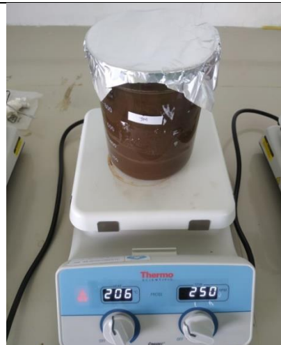
Ekstraksi 50 gram fly ash batubara menggunakan 1 L KOH 3 M dan pengadukan 250 rpm menggunakan hot plate dan magnetic stirrer
