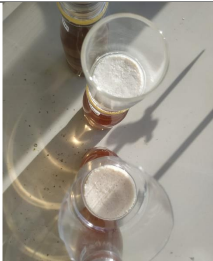
Membran silika variasi B4 (KOH 3 M; silika 3 gram; PVA 0,7 gram)
