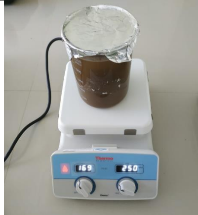
Pencucian 100 gram fly ash batubara menggunakan 1 L aquades dan pengadukan 250 rpm menggunakan hot plate dan magnetic stirrer
