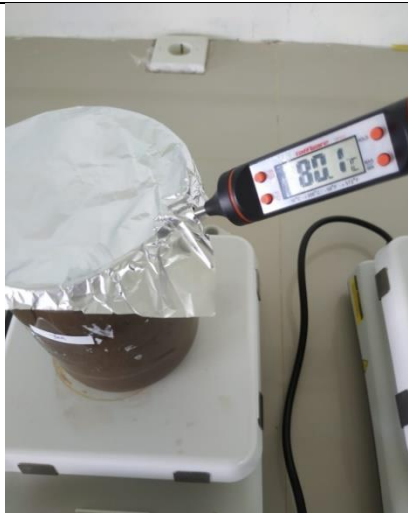
Ekstraksi 50 gram fly ash menggunakan KOH 2 M dan 3 M hingga suhu 80°C selama 1 jam
