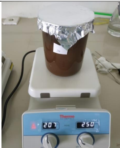
Ekstraksi 50 gram fly ash batubara menggunakan 1 L KOH 2 M dan pengadukan 250 rpm menggunakan hot plate dan magnetic stirrer
