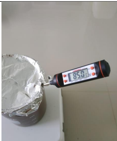
Pencucian fly ash batubara hingga suhu 85°C selama 2 jam
