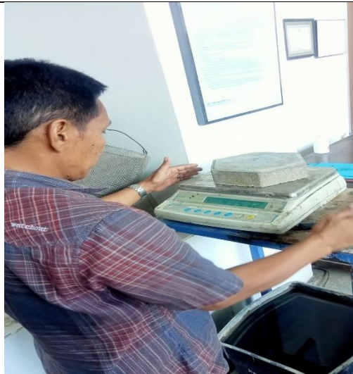
Proses penimbangan sampel sebelum uji Ketahanan Aus
