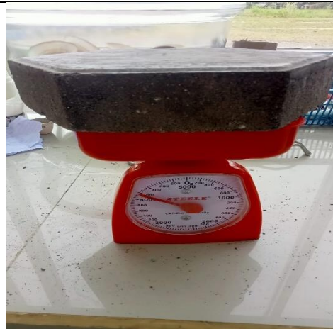
Proses Penimbangan sampel setelah uji natrium sulfat
