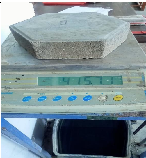
Proses penimbangan sampel sesudah uji Ketahanan Aus
