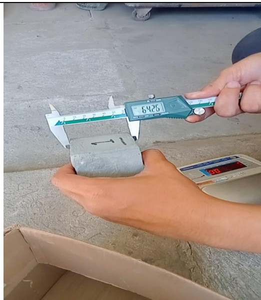
Proses pengukuran sampel untuk uji kuat tekan
