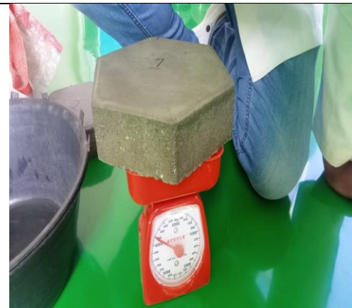
Proses Penimbangan Setelah Dilakukan Uji Penyerapan Air
