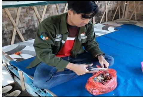
Proses Pencacahan Plastik Multilayer
