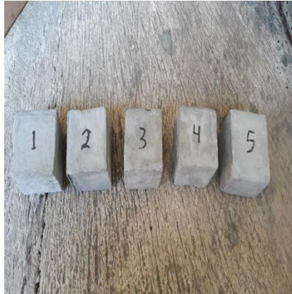
Sampel dipotong dengan ukuran 6x6 cm
