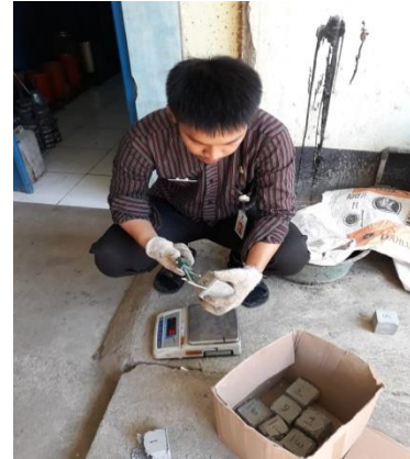
Pengukuran sampel sebelum uji kuat tekan
