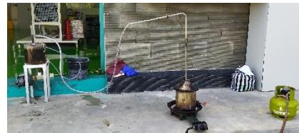
Rangkaian alat pirolisis dan rancangan awal sistem pemisah fasa cair dan gas
