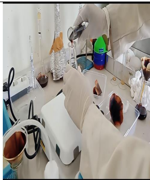
Uji karakteristik karbon aktif (uji daya serap iodin)
