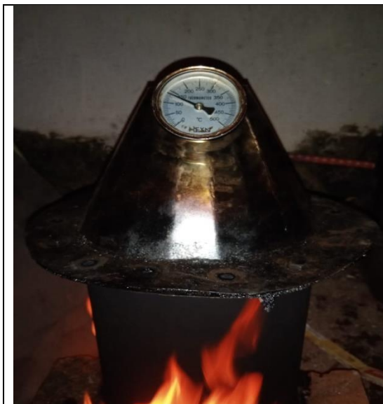
Proses karbonisasi menggunakan alat pirolisis
