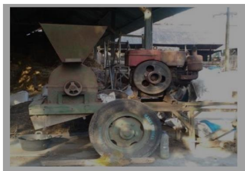
Gambar 2.1 Desain mesin penghancur kotoran kambing dengan sudu berbentuk martil (Nadliloh, 2019)
