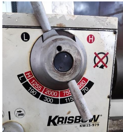
Gambar 2A Variasi kecepatan spindle mesin bubut
