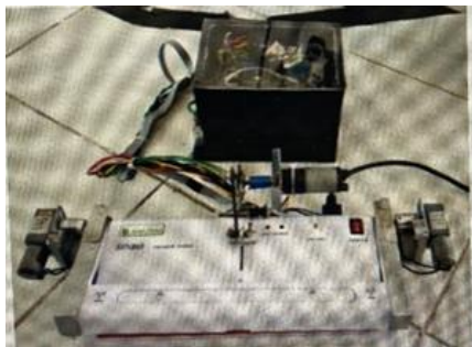
Gambar 2.1 bentuk fisik mesin press vacuum sealer (Cahyono dkk, 2021)
