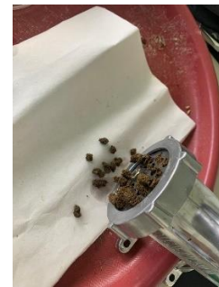
Proses pencetakan pellet pakan unggas
