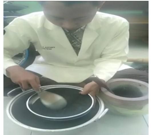
setelah ditumbuk Sekam Padi diayak menggunakan mesh 30
