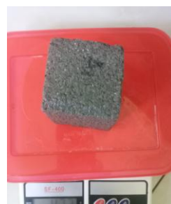
Pengujian Penyerapan Air
