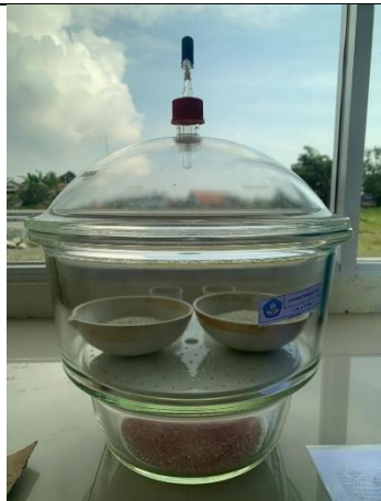
Proses Pendinginan di Desikator
