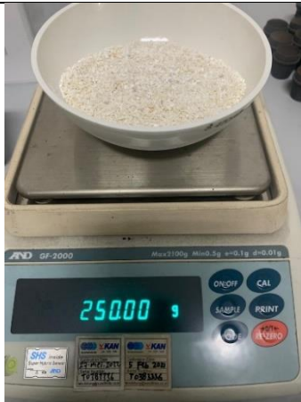
Proses Penimbangan Cangkang Kerang Darah sebelum Kalsinasi
