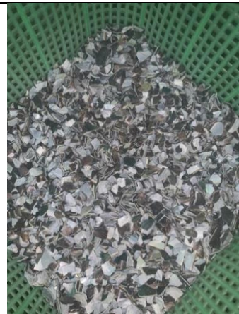
Proses Penumbukan Kasar Cangkang Kerang
