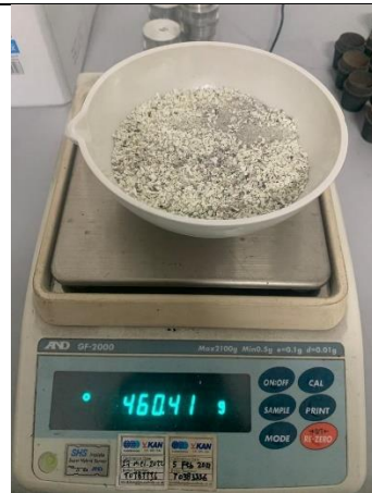
Proses Penimbangan Sampel Cangkang Kerang Darah Setelah di Kalsinasi
