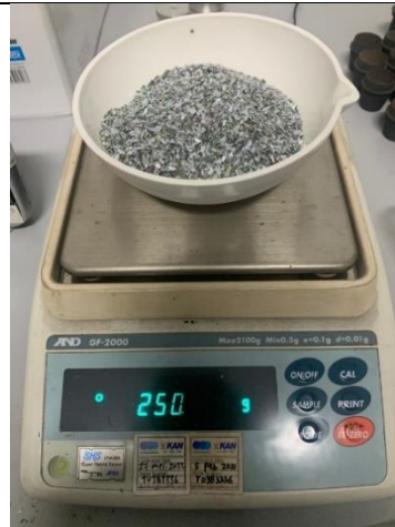
Proses Penimbangan Cangkang Kerang Hijau sebelum Kalsinasi
