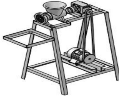
Gambar 2. 2 Mesin penggiling ketela dalam pembuatan getuk menggunakan penggerak dinamo (Siagian dkk, 2023)
