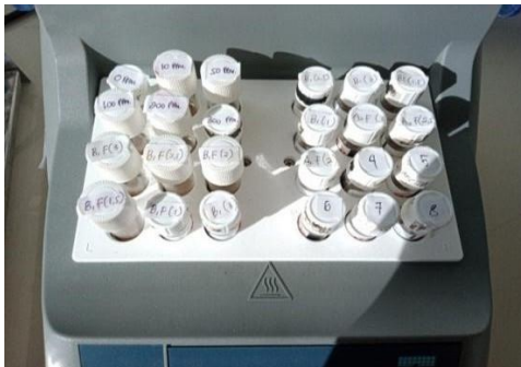
Pemanasan Sampel Uji dalam COD Reaktor
