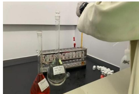
Pembuatan Larutan Digestion Solution dan Larutan Peraksi dan Pengisian dalam Tabung COD
