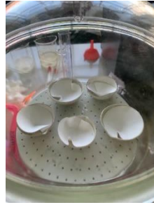
Desikator kertas saring setelah pengovenan selama 15 menit untuk pengujian parameter TSS
