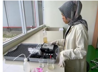
Pengujian parameter kekeruhan menggunakan alat turbiditymeter
