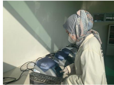
Pemanasan reagent menggunakan COD reaktor dengan suhu 150 °C selama 2 jam
