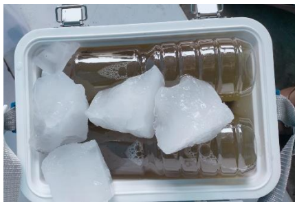
Pengiriman sampel untuk pengujian diluar menggunakan ice box
