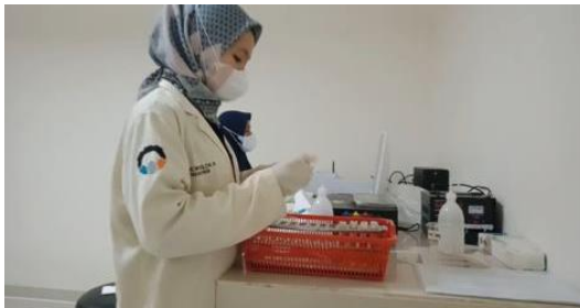
Pengujian parameter COD dengan alat spektrofotometer
