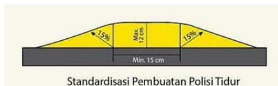
Gambar 2.24 Dimensi standar polisi tidur (Keputusan Menteri Perhubungan Nomor 3 Tahun 1994)
