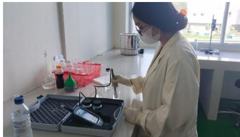
Pengukuran salinitas menggunakan conductivity meter
