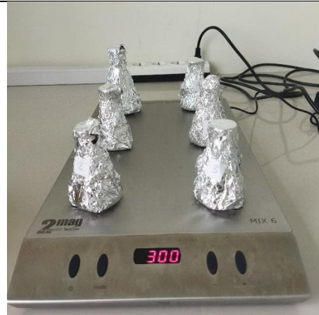
Pengadukan sampel dengan magnetic stirer untuk pengujian daya serap iodin
