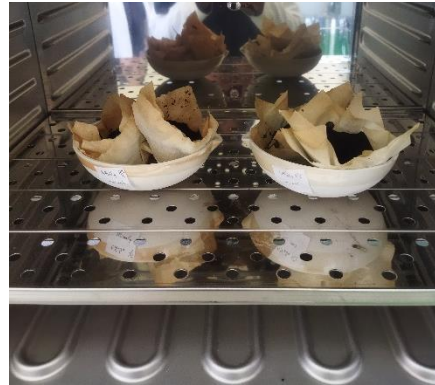
Pengeringan Karbon aktif dengan oven pada suhu 105°C
