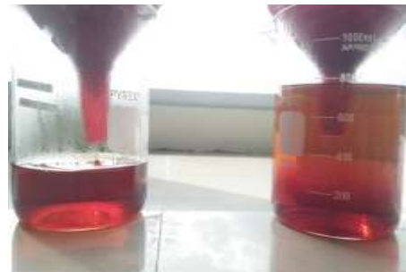
Proses penyaringan dan Penetralan pada tahap bleaching
