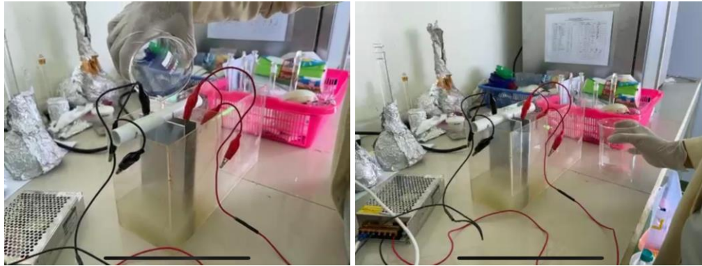
Lampiran 2.7 Pemasukan Limbah, Proses Elektrokoagulasi
