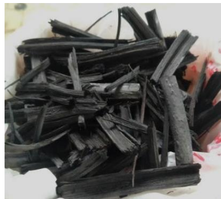
Hasil karbonisasi pelepah nipah \pm 7 hari pengeringan pada suhu 300^{\circ}\text{C} selama 2 jam
