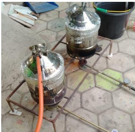
Proses karbonisasi menggunakan alat pirolisis
