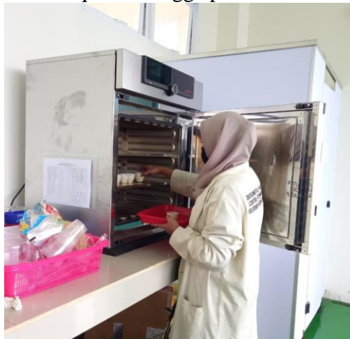
Pengujian kadar air karbon aktif menggunakan drying oven
