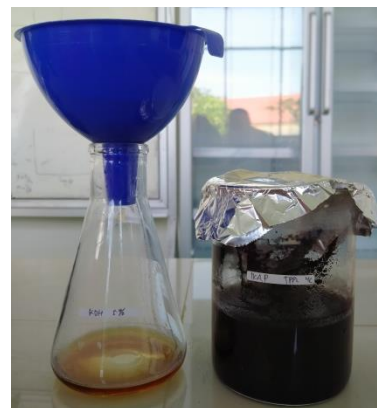
Proses penyaringan karbon aktif setelah perendaman 24 jam
