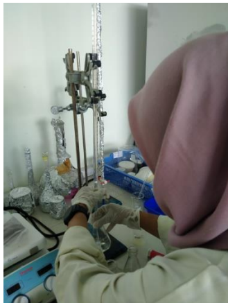
Pengujian kadar klorin bebas ( \text{Cl}_2 ) pada sampel PDAM dan sampel hasil adsorpsi
