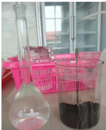
Perbandingan larutan aktivator dengan karbon aktif 250ml : 30 gram
