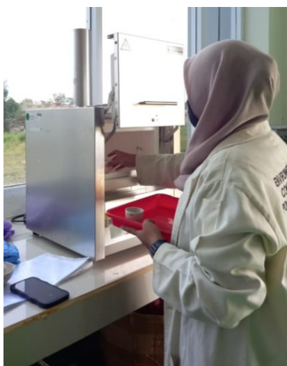
Pengujian Kadar Abu Karbon Aktif menggunakan furnace
