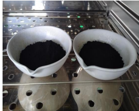
Proses pengeringan menggunakan oven sampai berat konstan
