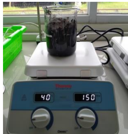
Proses aktivasi kimia menggunakan H_2SO_4 , KOH dan NaCl dengan konsentrasi 5%
