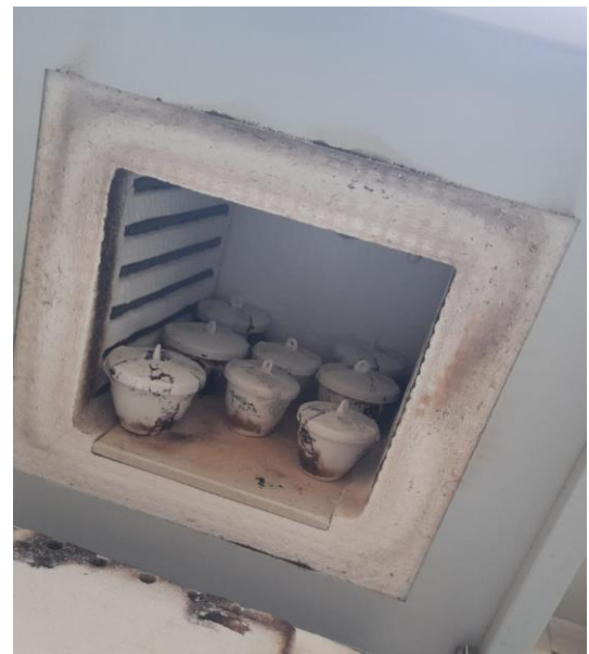
Karbonisasi menggunakan furnance dengan suhu 400°C selama 2jam
