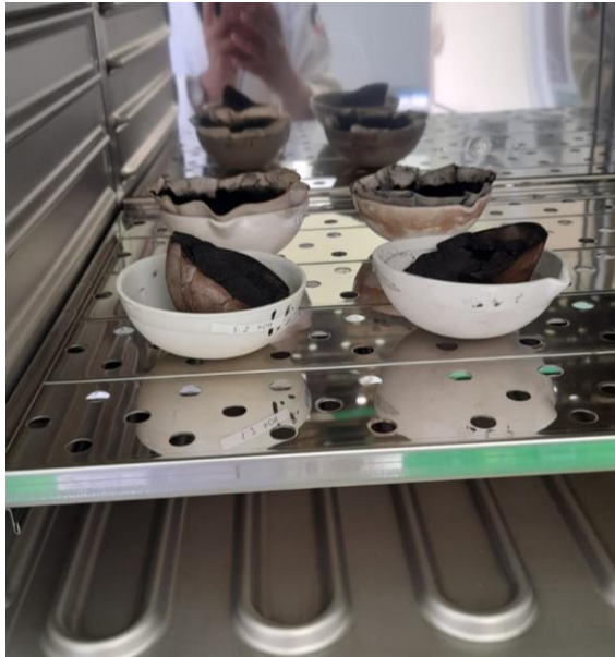
Proses pengeringan menggunakan oven dengan suhu 105^{\circ}\text{C} selama 1 jam hingga konstan
