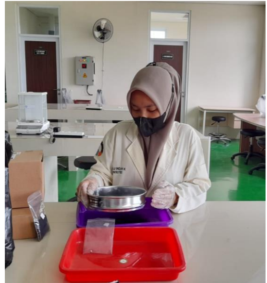
Proses pengayakan dengan ukuran 100 mesh
