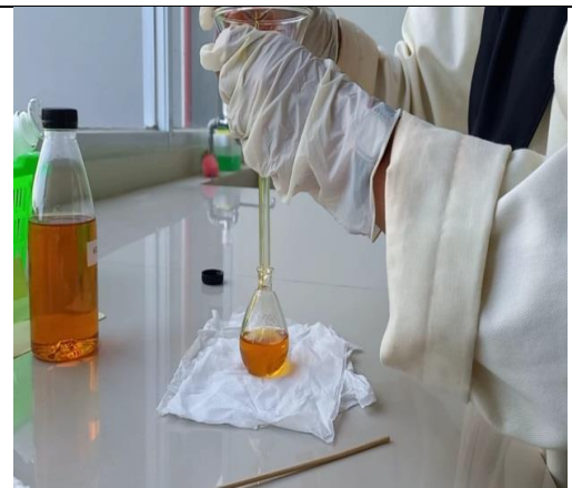
Pengisian biodiesel ke piknometer
