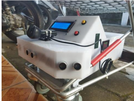
Gambar (f) Posisi Sensor Ultrasonik Bagian Kiri
