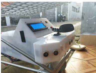
Gambar (e) Posisi Sensor Ultrasonik Bagian Kanan
