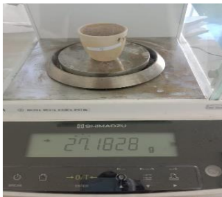
Analisa Kadar Abu Kitosan
