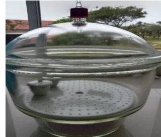
Analisa Kadar Air Kitosan
